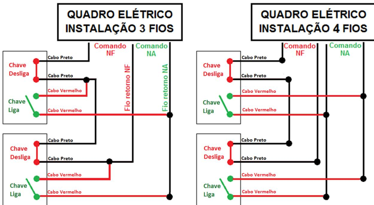
**Observação:** Em sistema de 3 Fios pode ser realizado o jumper dos cabos preto e vermelho dentro do próprio dispositivo.
